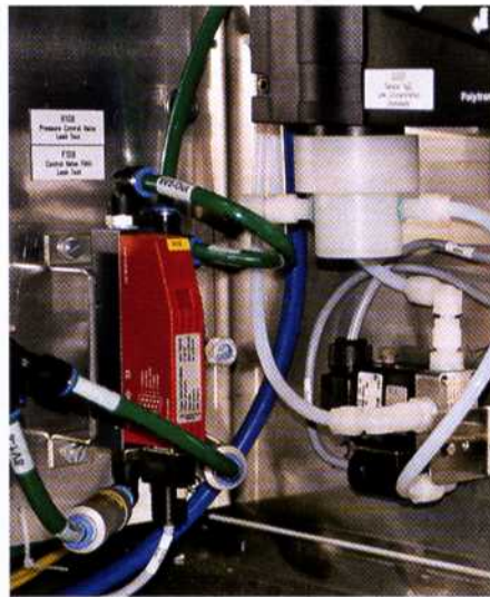
Kunststoffverbindungen aus PVDF und Schläuche aus Teflon sorgen für Sicherheit
